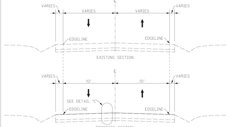
PROPOSED SECTION STA. 506+04 - STA. 710+00 STA. 711+15 - STA. 826+69
